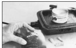
Tenga usted el molde en la mano izquierda y aprete dos o tres dedos contra el dorso del molde para ayudar en "empujar" el patrón. - A la vez doble usted el molde por presionar con la mano derecha sobre el otro cabo del molde, como ilustrado.
